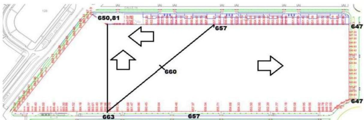
Conjugando ambos datos, se establece una condición normativa de altura máxima del lado de la seguridad, por la que la altura de la edificación no podrá superar en ningún punto un plano inclinado ideal definido con sus líneas de nivel orientadas en sentido norte sur, y cotas + 31,00 m en el frente a Manuel Fraga ( $678 \text{ m} - 647 \text{ m} = 31 \text{ m}$ ) y de + 37,00 m en el lindero con la parcela del intercambiador ( $700 \text{ m} - 663 \text{ m} = 37 \text{ m}$ ); en ambos casos
